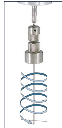
점도계에 T-Bar 스펀들을 장착 상하로 이동하며 나선형 모양으로 점도를 측정합니다.
