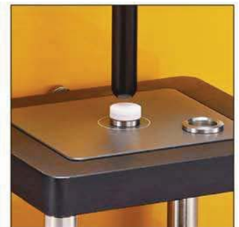
TA-TCF (P) (Tablet Compression Fixture) Tablet을 으러뜨리는데 드는 힘을 측정하며 4개의 다른 직경을 가진 ring 기본 포함 • Fixture Base Table 필요
