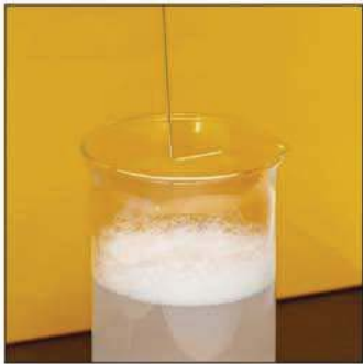
TA-RT (P) (Raft Tester) Hook 어댑터와 Wire probe로 구성되어 Wire를 Alginate raft에서 당기는 힘을 측정 제산제, 위장약 등에 적용
