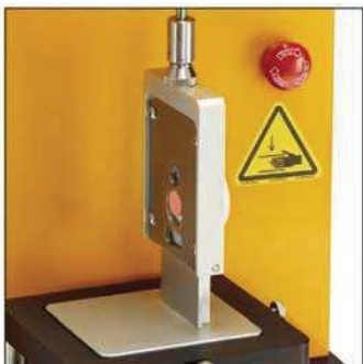
TA-BLS (P) (Bi-Layer Shear Fixture) 전단 강도를 측정하는 동안 이중층 tablet을 분리하는 데 guillotine blade를 사용 • Fixture Base Table 필요
