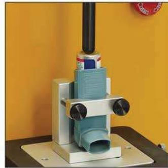
TA-MDI (P) (Metered Dose Inhaler Fixture) 네블라이저를 작동시키는 Push-button을 누르는 힘 측정 • Fixture Base Table 필요
