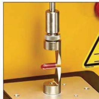
TA-CLT (P) (Capsule Loop Tensile Test Fixture) Hard gel capsule의 반쪽을 찢는데 드는 힘을 측정 • Fixture Base Table 필요
