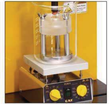
TA-MA (P) (Muco Adhesion Test Fixture) 표면으로부터 table을 잡아 당기는데 필요한 힘과 신체, 온도 조건을 모의 실험하여 점막에서 table 점착성 측정
