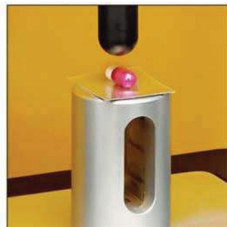
TA-BPS (P) (Bilster Pack Support Fixture) Tablet을 bilster pack으로부터 분리할 때 필요한 힘을 측정 • Fixture Base Table 필요
