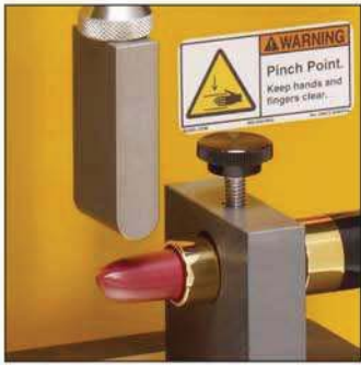
TA-LC (C) (Lipstick Cantilever Test Fixture) 립스틱과 같은 제품의 강도 측정 • Fixture Base Table 필요
